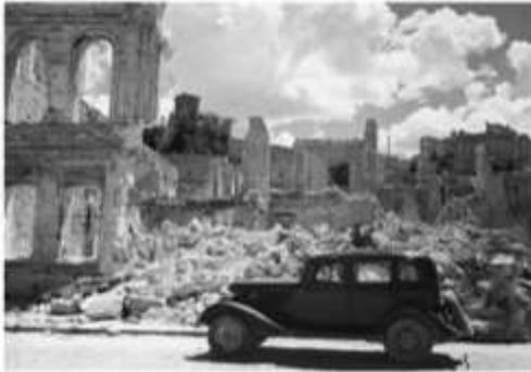
"Эмка" - основной легковой автомобиль Горьковского завода ГАЗ-М1 - выпускалась с 1936 по 1946 год, в последние 5 лет в модификации И1-76 с шестицилиндровым двигателем. В основе модели - модернизированная советскими инженерами конструкция Ford V8 1934 года с четырехцилиндровым двигателем. Автомобиль показал себя чрезвычайно надежным и проходимым, а также, что было важно в военных условиях, неприхотливым.
