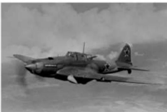
Разработанный в 1939 - 1941 годах бронированный штурмовик Ил-2 с пушечным вооружением конструкции КБ Ильюшина оказался одной из лучших боевых машин Второй Мировой войны. До конца 1942 года Ил-2 выпускались одноместными, однако потери самолетов из-за отсутствия бортстрелка были достаточно велики, и в модификации Ил-2М двухместная кабина появилась, пусть и не целиком защищенная бронекорпусом. Полноценная защита у второго члена экипажа появилась лишь в 1944 году, на модели Ил-10.
