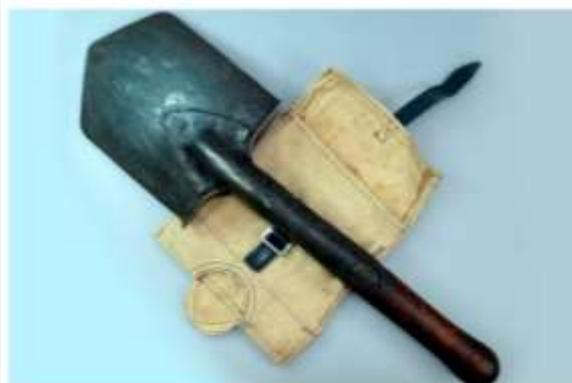
Для окапывания боицу полагалась малая пехотная лопата МПЛ-50 (50 см — общая длина лопаты; при сапёрных работах и строительстве она использовалась и как мерительный инструмент). К 1941 году в Красной Армии использовались, как лопаты дореволюционного образца с прямой режущей кромкой, так и советские, у которых передняя часть имела заострённый конец для облегчения окапывания, а само лезвие имело пятиугольную форму.
