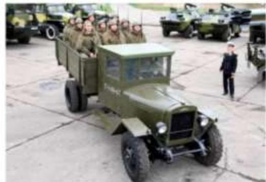
Московский трехтонный грузовик Зис-5 был одной из главных "рабочих лошадок" армии на протяжении войны. По грузоподъемности и проходимости он уступал лишь американскому "Студебеккеру". Конструкция "Захара" - так его прозвали фронтовые шоферы - была простой и неприхотливой, не требовала (в отличие от немецких машин) квалифицированного сервиса. Зис-5 продолжали выпускать в Москве, а после на Уральском филиале завода, до середины 1950-х годов.
